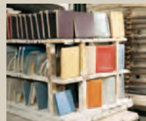
Im Brennofen werden die glasierten Kacheln bei ca. 1.040 °C ca. 28 Stunden gebrannt.
