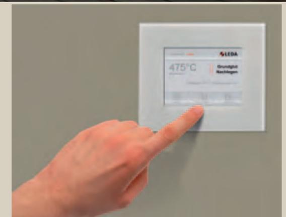
Automatischer Heizkomfort auf Wunsch. Die ausgereifte Regелеlektronik der Abbrandsteuerung ist kinderleicht zu bedienen. Sie sichert die optimale Luftzufuhr für einen hohen Wirkungsgrad, schadstoffarme Verbrennung und weniger Holzverbrauch.
